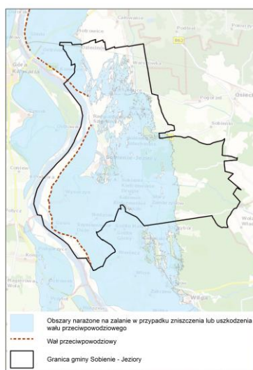
Rycina 9. Obszary narażone na zalanie w przypadku zniszczenia lub uszkodzenia wału przeciwpowodziowego.
